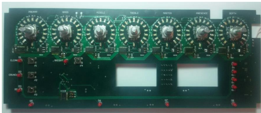
Figura 43: “Vista cara Top de la pcb del footswitch con los componentes”
