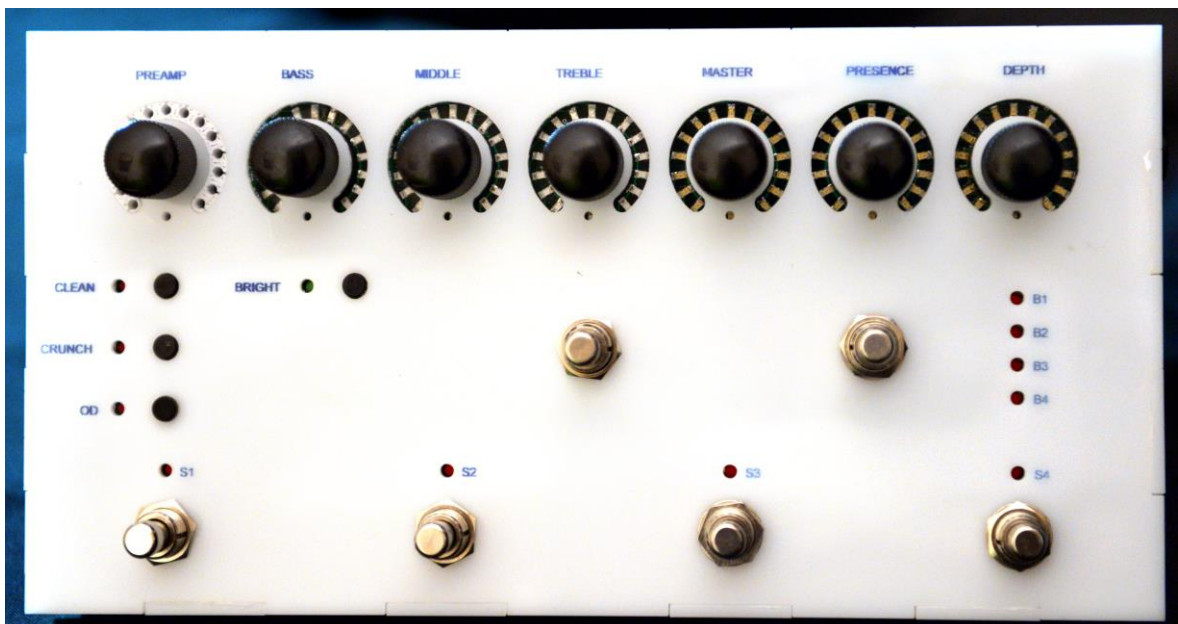
Figura 49: “Construcción del prototipo para el footswitch”
