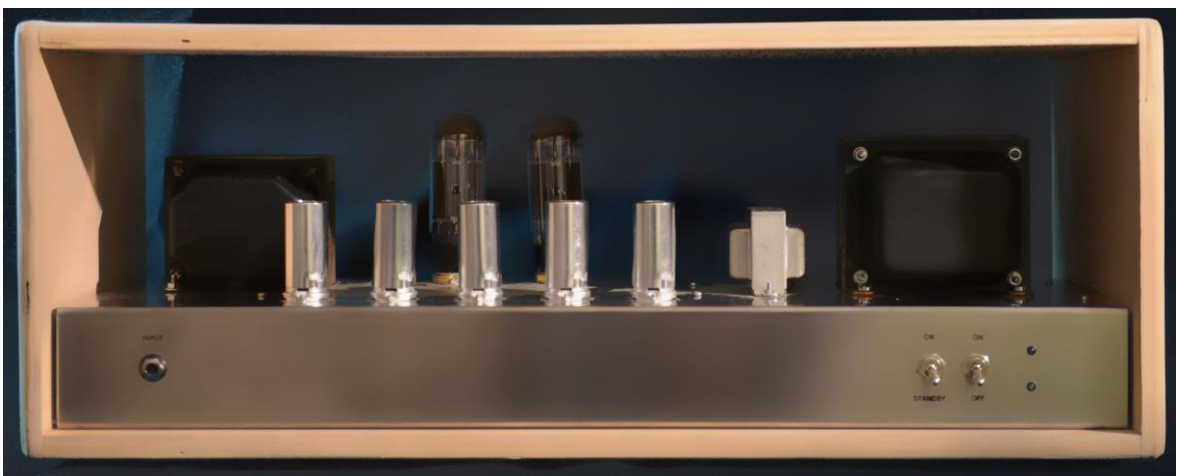
Figura 48: “Construcción final del amplificador montado en su cajón de madera”
