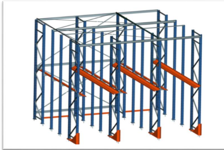
Ilustración 17. Detalle de las estanterías de paletización. Fuente: KaiserKraft
