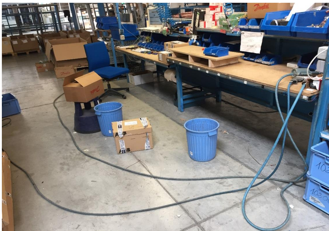
Figura 49 - Imagen de uno de los puestos con las mangueras por el suelo para herramienta neumática.
