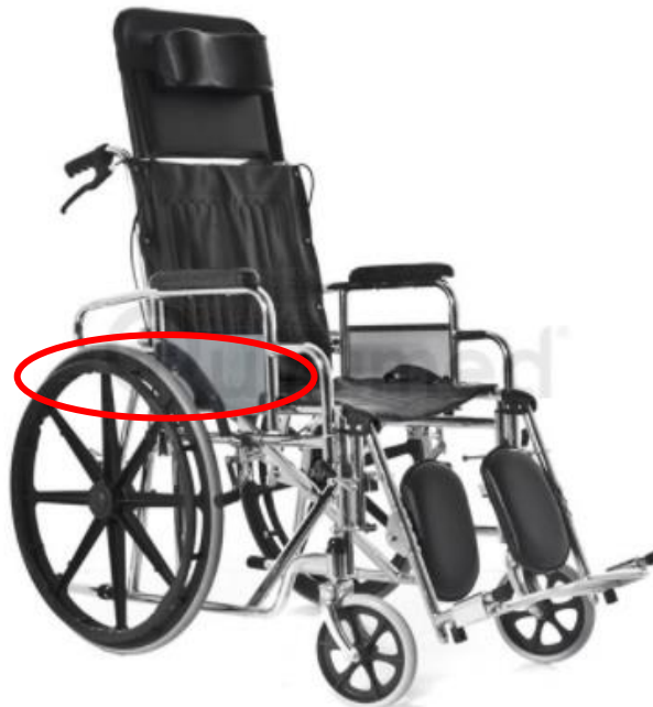
Figura 8; El diámetro de la rueda trasera impide la maniobra. Fuente: (Quirumed, Health & Beauty, 2017)
