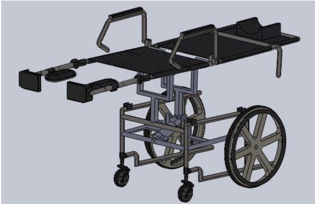
Figura 35; Silla elevada a su altura máxima. Fuente: Elaboración propia
