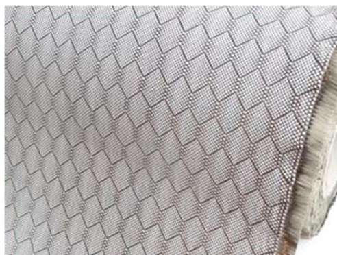
Fig. 13 Tejido + fibra de basalto + innegra
