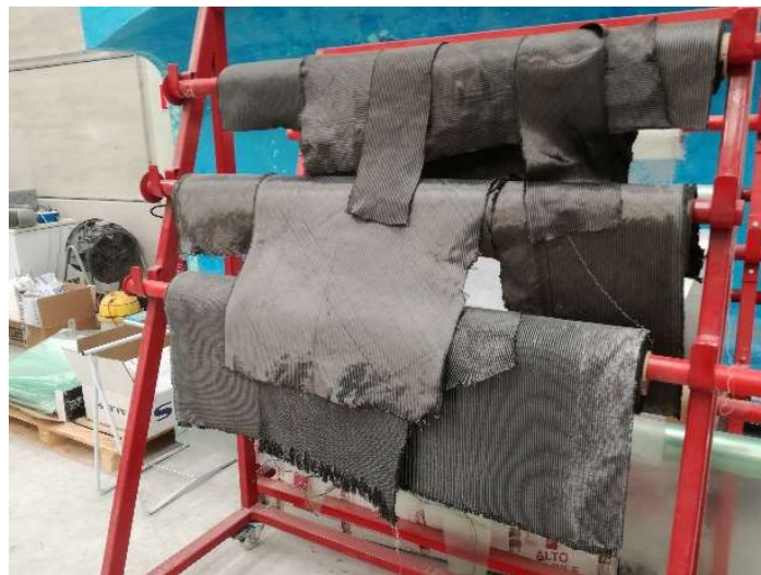
Fig. 32 Soporte con los tejidos disponibles de fibra de carbono
