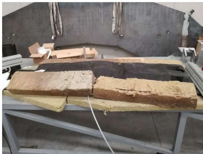
Fig. 40 Aislamientos laterales en el conjunto
