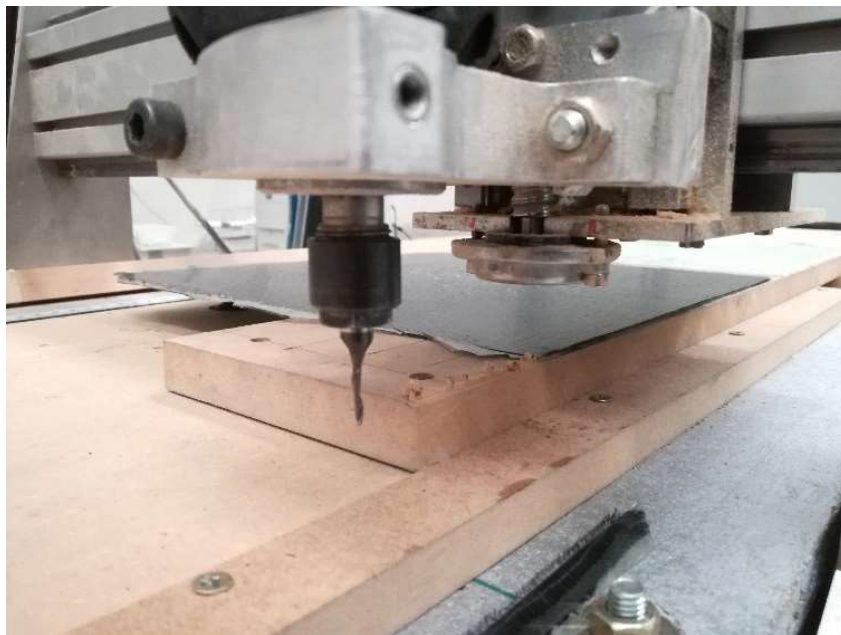
Fig.44 Detalle del ajuste en cotas de las planchas con la fresa
