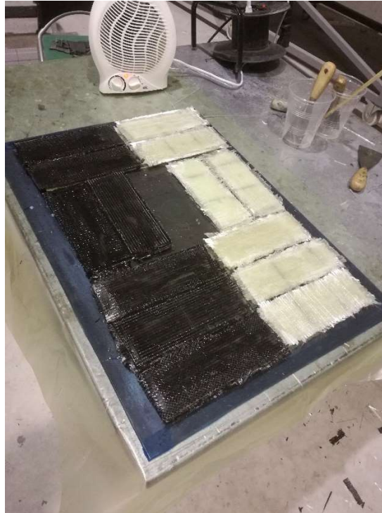
Fig. 51 Finalización del apilado de las probetas sandwich
