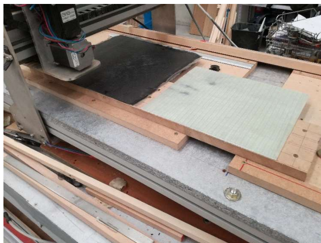
Fig. 43 Montaje de las planchas en la fresadora
