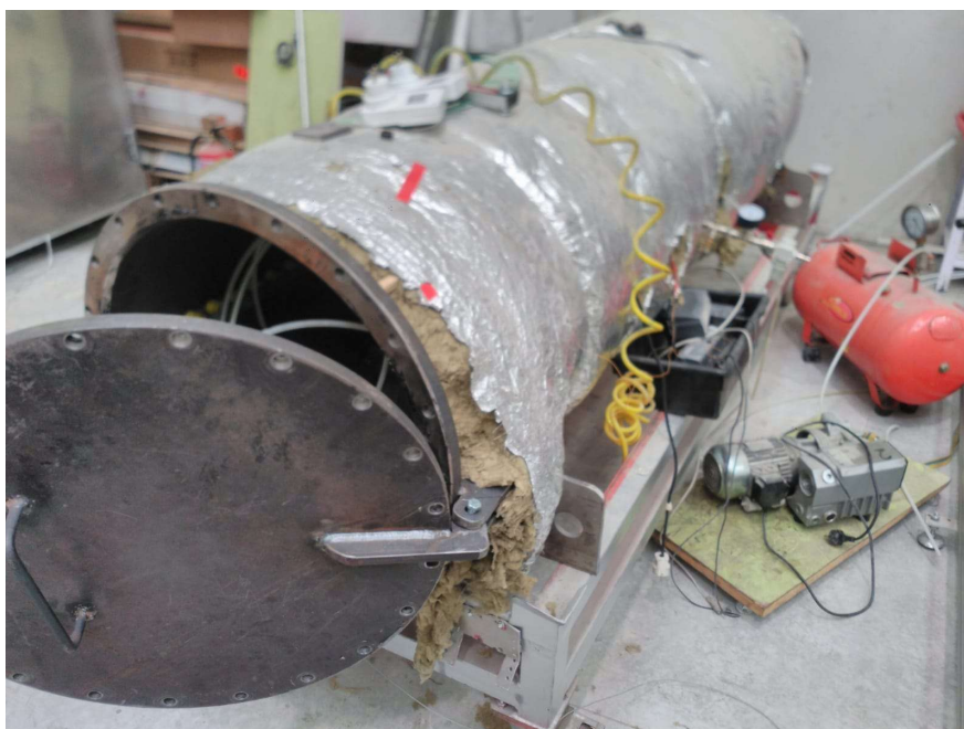
Fig. 54 Autoclave empleado en el proceso de curado
