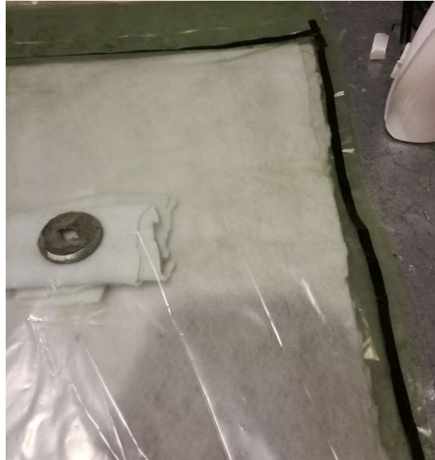
Fig. 53 Detalle del cierre de la bolsa de vacío
