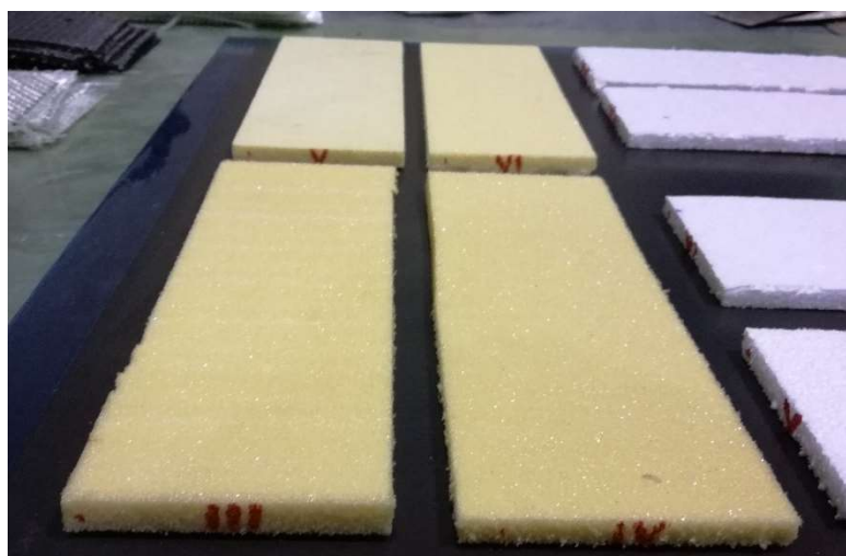
Fig. 47 Núcleos de corecell
