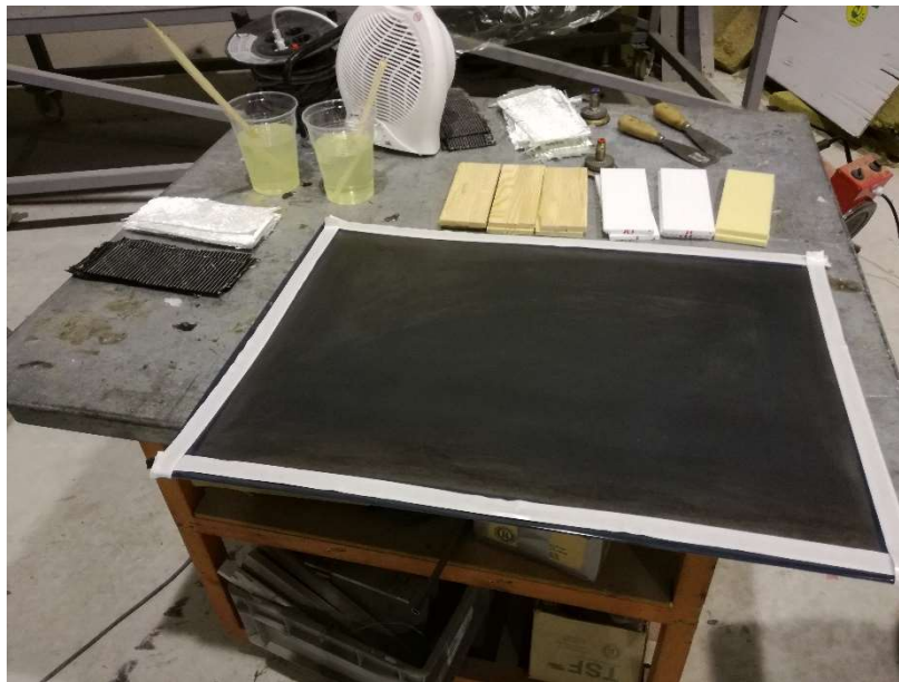
Fig. 49 Material preparado para iniciar el apilado
