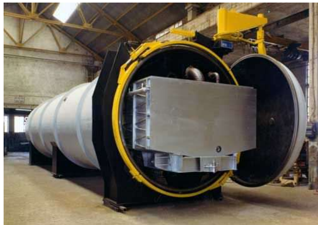
Fig. 21 Ejemplo de un autoclave industrial
