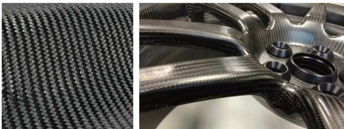
Fig. 9 Tejido y pieza, respectivamente, fabricadas con fibra de carbono
