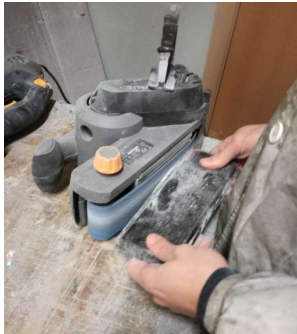
Fig. 56 Lijadora empleada para limpiar las muestras
