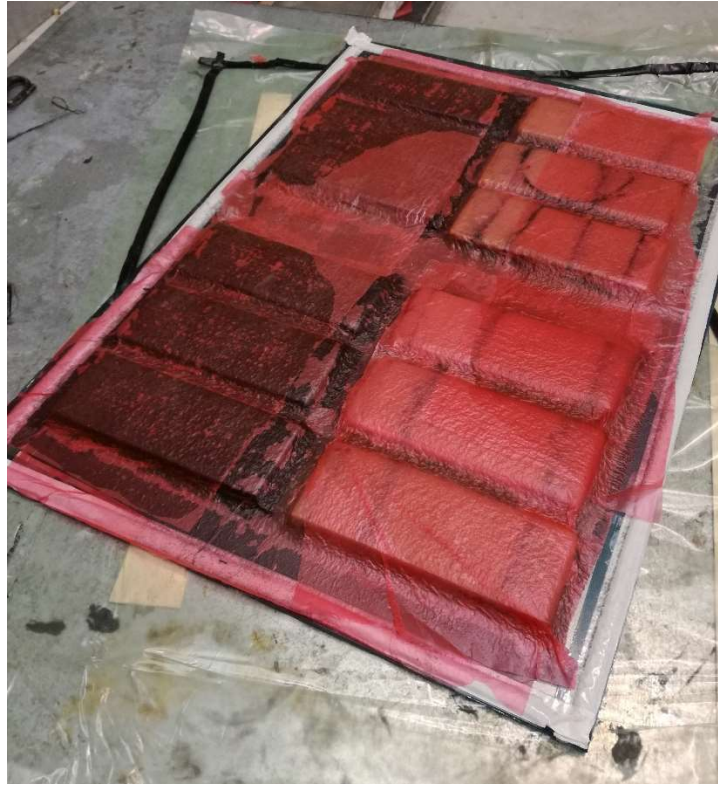
Fig. 55 Muestras sandwich ya curadas
