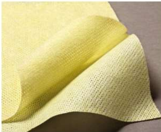
Fig. 10 Tejido de aramida y ejemplo de aplicación
