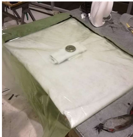
Fig. 52 Proceso de cierre de la bolsa de vacío
