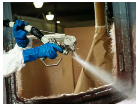
Fig. 19 Moldeo por proyección
