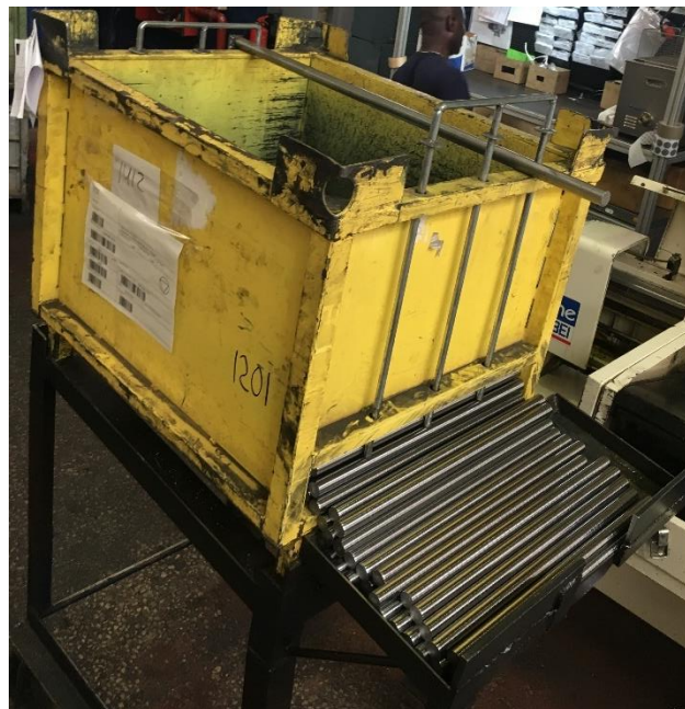
Figura 1. 4: Contenedor sobre estructura en el sistema original
