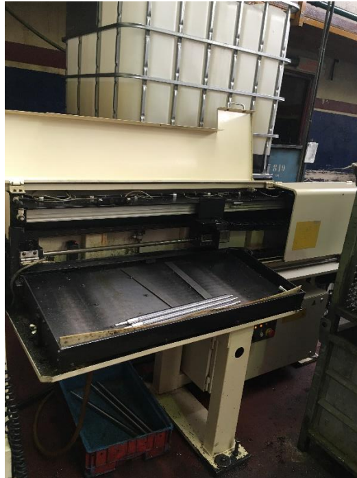
Figura 1. 6: Bandeja de salida del torno:
