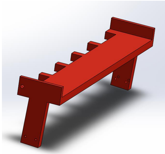
Figura 1. 15: Rampa inferior para alimentador de banda
