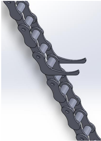
Figura 1. 13: Cadena con gancho para elevador con cadenas
