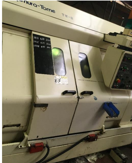
Figura 1. 7: Torno de control numérico
