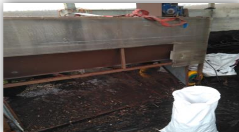
17. Irudia - Konposta kribatzeko makina semi- automatizatua. Iturria: Propioa
