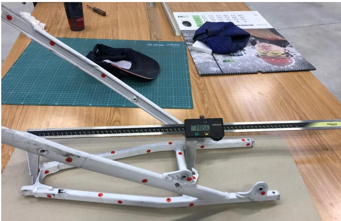
**Imagen 6.7. Sub-chasis con gomets rojos para la identificación de los puntos necesarios para la alineación de las fotografías del escáner.**
