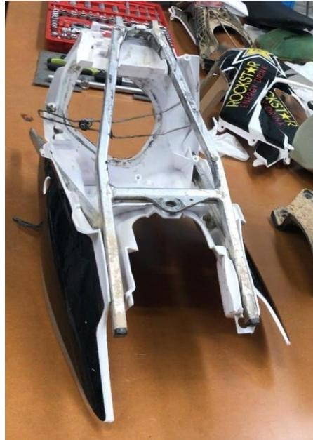
**Imagen 6.3. Sub-chasis desmontado con el carenado.**
