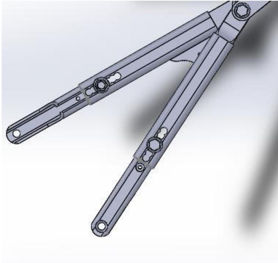
**Imagen 6.29. Ensamblaje de los brazos con sus articulaciones y la regulación de la altura mediante tornillos y tuercas.**
