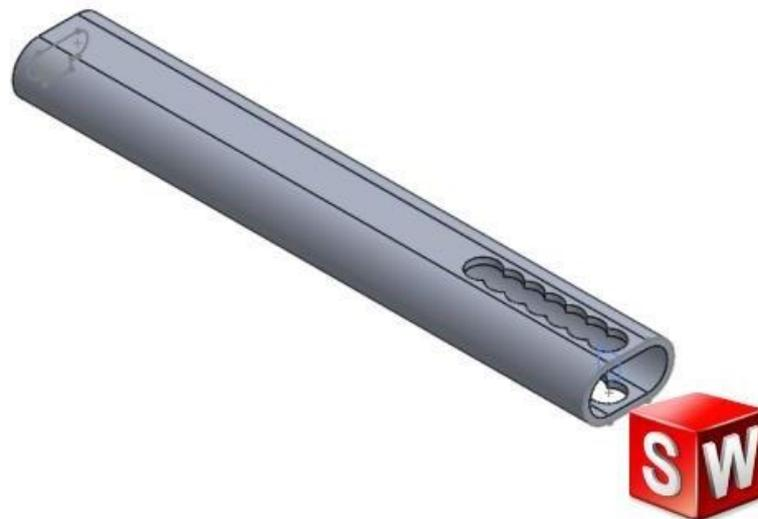
**Imagen 6.22. Parte externa brazo telescópico con ranura para regulación**
