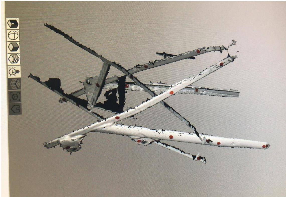
**Imagen 6.8. Captura de los diferentes escaneos antes de coserlos mediante alineación**
