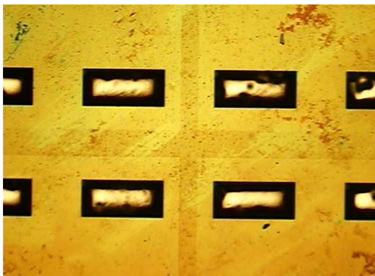
Ilustración 62: Excavado de los slots con 100 pasadas
