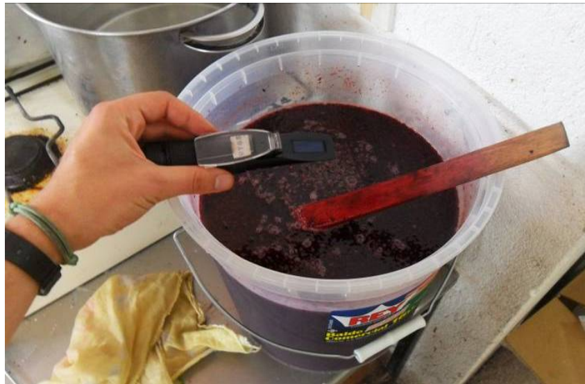
Figura 4.8 – Análisis de los sólidos solubles con el refractómetro.
