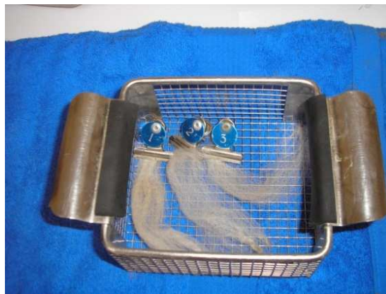
Figuras 2.26 y 2.27. Colocación de la grapa e introducción de las muestras en la rejilla para el lavado. Fuente: Autora.
