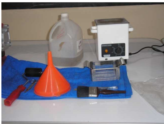
Figura 2.22. El aparato para el lavado de muestras Ultrasonic Cleaner. Fuente: Autora
