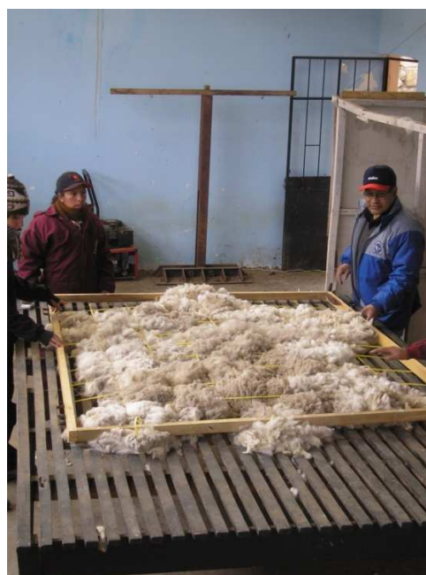
Figuras 2.18 y 2.19. Ubicación del vellón entero sobre la mesa de muestras y posterior colocación de la rejilla de muestreo sobre éste. Fuente: Elorza A.
