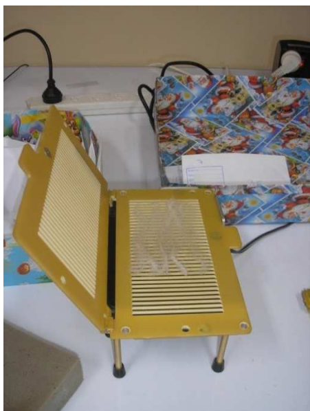
Figura 2.24 y 2.25. Colocación de la muestra en el porta-muestras y de este en el OFDA. Fuente: Autora
