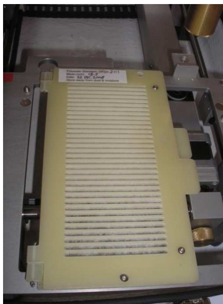
Figura 2.24 y 2.25. Colocación de la muestra en el porta-muestras y de este en el OFDA. Fuente: Autora
