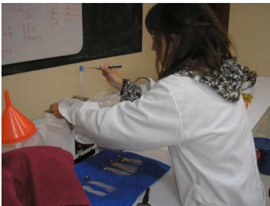
Figuras 2.28 y 2.29. Equipo de lavado Ultrasonic Cleaner en funcionamiento. Fuente: Autora.
