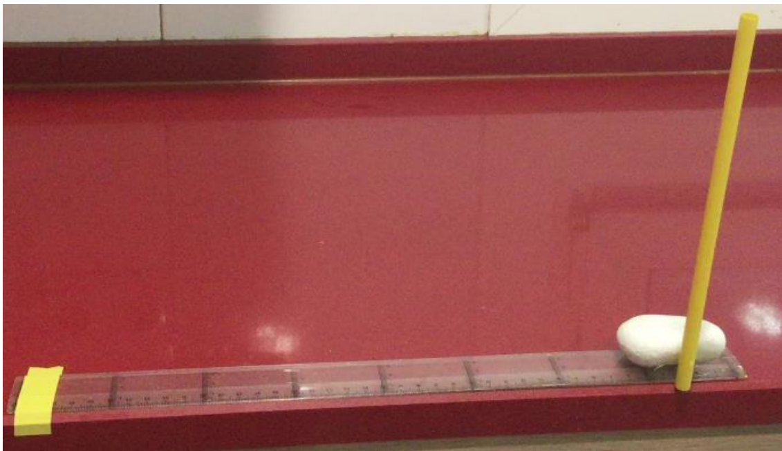
Figura 15. Dispositivo experimental para el estudio de la dilatación de sólidos.
