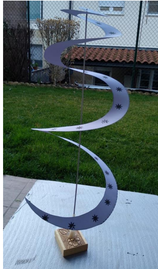
Figura 6. Dispositivo experimental para el estudio de convección.
