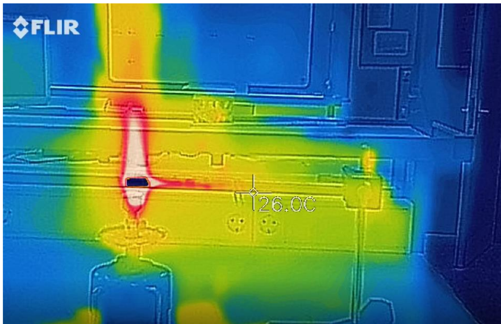
Figura 3. Fotografía con la cámara térmica de la barra de metal al ser calentada con una llama.
