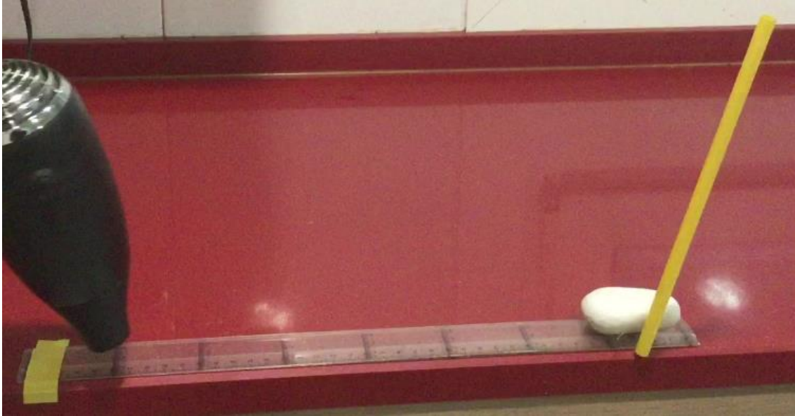
Figura 16. Dispositivo experimental para el estudio de la dilatación de sólidos tras calentar la regla con un secador. La dilatación de la regla provoca que el alambre gire en la dirección de dilatación de forma que se inclina la pajita.
