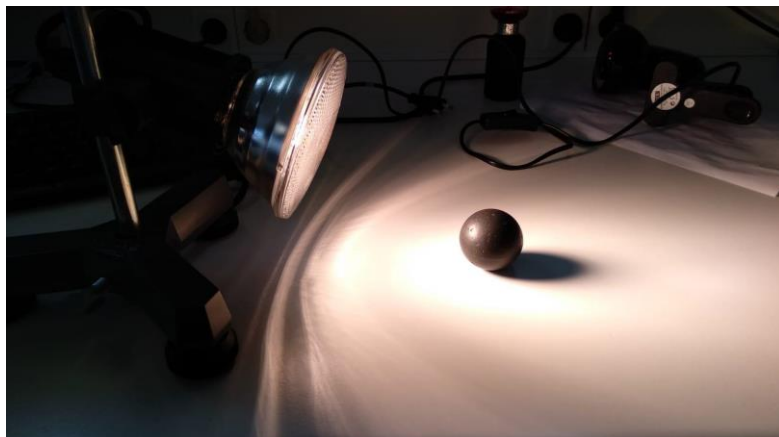
Figura 7. Dispositivo experimental para el estudio de la transferencia de calor por radiación.
