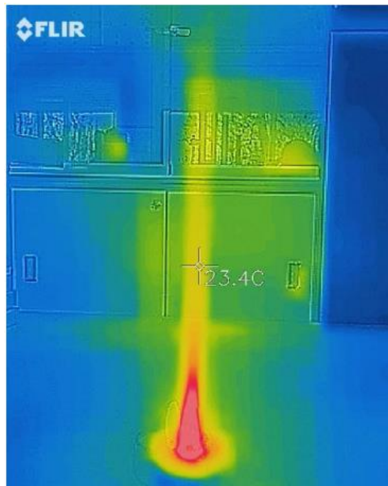
Figura 5. Fotografía con la cámara térmica de una vela encendida.
