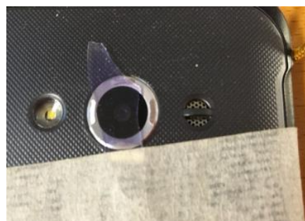
Ilustración 2: Red de difracción obtenida de un DVD colocada sobre la cámara trasera de un móvil Android
