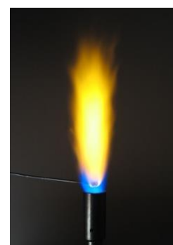
Ilustración 1 Ensayo a la llama para el sodio, correspondiente a su doble línea D en los 589 nm
