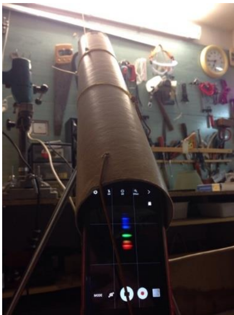
Ilustración 3: Sensor acoplado al tubo óptico y mostrando la imagen del espectro de un tubo fluorescente
