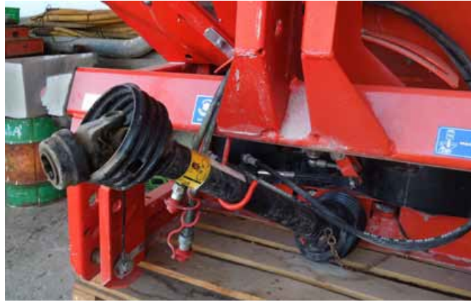
Dispositivo amovible con resguardo
