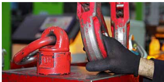
Accesorio de elevación como parte de la carga
