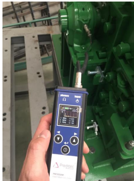
Figura50. Gráfica de frecuencias obtenidas en la puesta en marcha de un molino impactor
