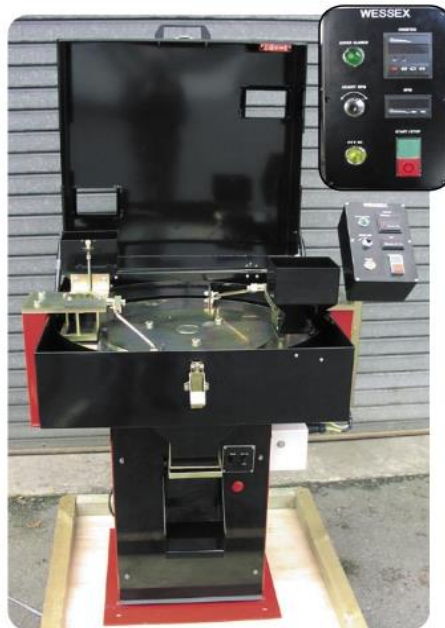
Figura4. Equipo para determinar el índice de abrasión
