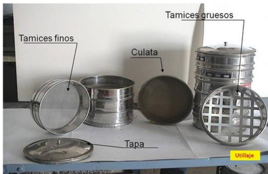
Figura6. Material para el análisis granulométrico
