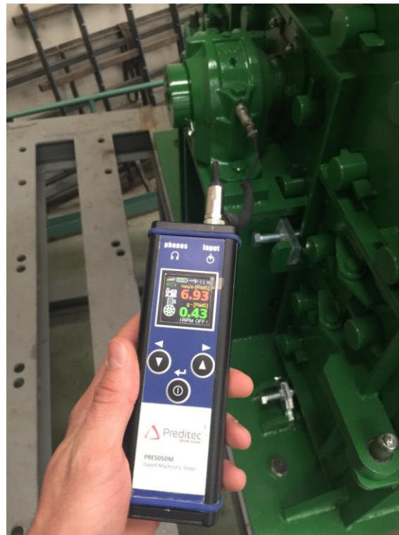
Figura48. Medición de las vibraciones en la puesta en marcha de un molino impactor
