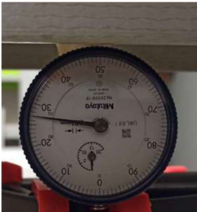
Fig.64 Detalle de medición de deformación (0.27mm) de viga H100.100.6 con 11.9kg girada 90° (código 5)
