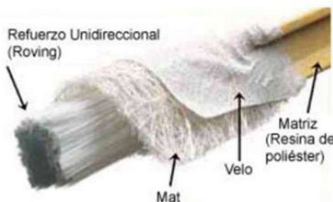
Fig.20 Detalle de la composición de los perfiles de PRFV (el velo de superficie tiene una disposición similar a un mat pero con un gramaje y un contenido en fibra muy inferiores) [8]
