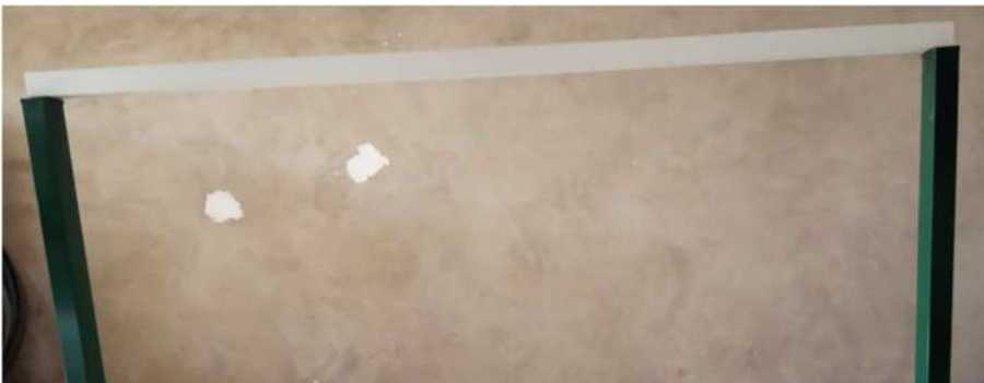
Fig.58 Vista general de una viga biapoyada
