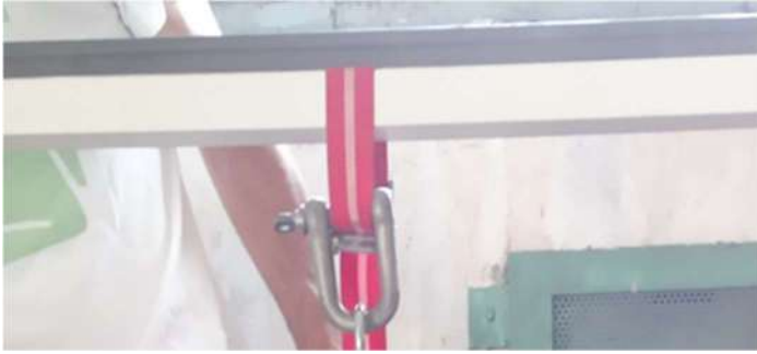
Fig.60 Detalle de cincha con peso colgada de la viga
