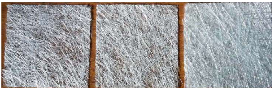
Fig.11 Ejemplos de mats de fibra de vidrio de 225, 300 y 450 g/m 2
