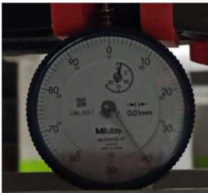
Fig.67 Detalle de medición de deformación (1.39mm) de viga H100.100.6 con 67.7kg (código 5)
