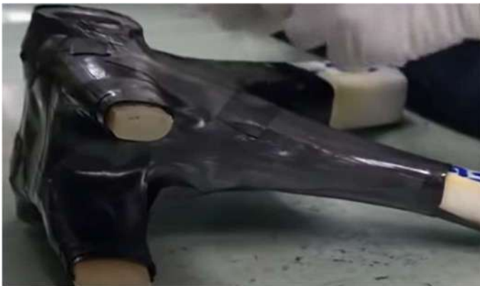
Fig.23.b Capas de parches de láminas preimpregnadas colocadas sobre núcleos extraíbles en la sección del pedalier del cuadro.
