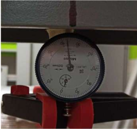
Fig.69 Detalle de medición de deformación (1.43mm) de viga H100.100.10 con 67.7kg girada 90° (código 11)
