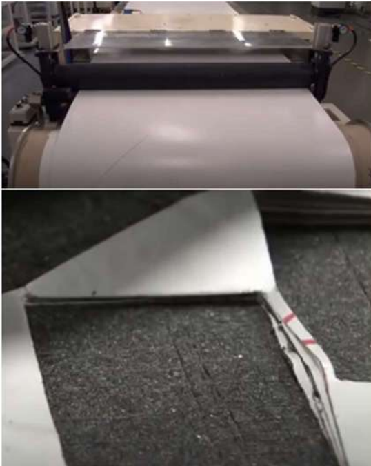
Fig.23.a Lámina de preimpregnados en bobina y detalle de recorte para “parches”. Obsérvese el papel protector (normalmente de polietileno o de silicona) de color blanco y la propia lámina de refuerzo de color negro. [19]
