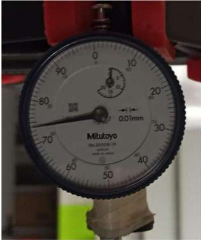
Fig.66 Detalle de medición de deformación (0.74mm) de viga H100.100.6 con 67.7kg (código 4)
