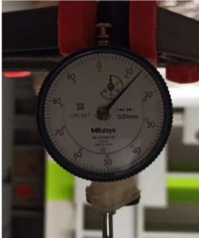
Fig. 63 Detalle de medición de deformación (0.13mm) de viga H100.100.6 con 11.9kg (código 4)
