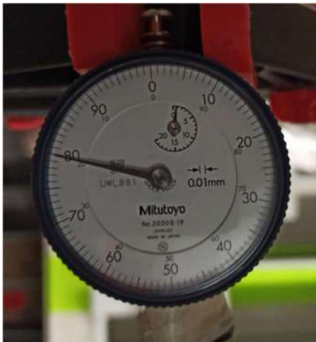
Fig.68 Detalle de medición de deformación (0.80mm) de viga H100.100.10 con 67.7kg (código 10)
