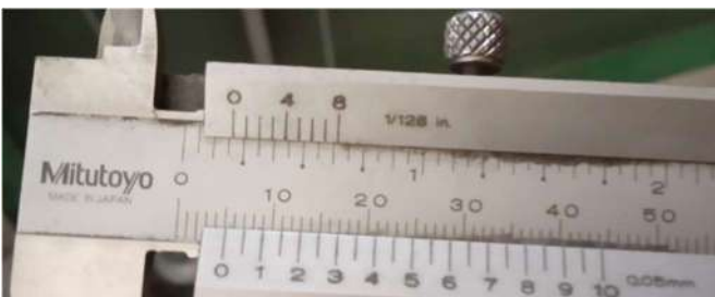
Fig.59 Calibre empleado en medir la distancia entre pletina calibrada y parte superior del perfil PRFV
