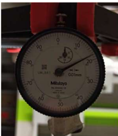
Fig.65 Detalle de medición de deformación (0.18mm) de viga H100.100.10 con 18.5kg (código 10)
