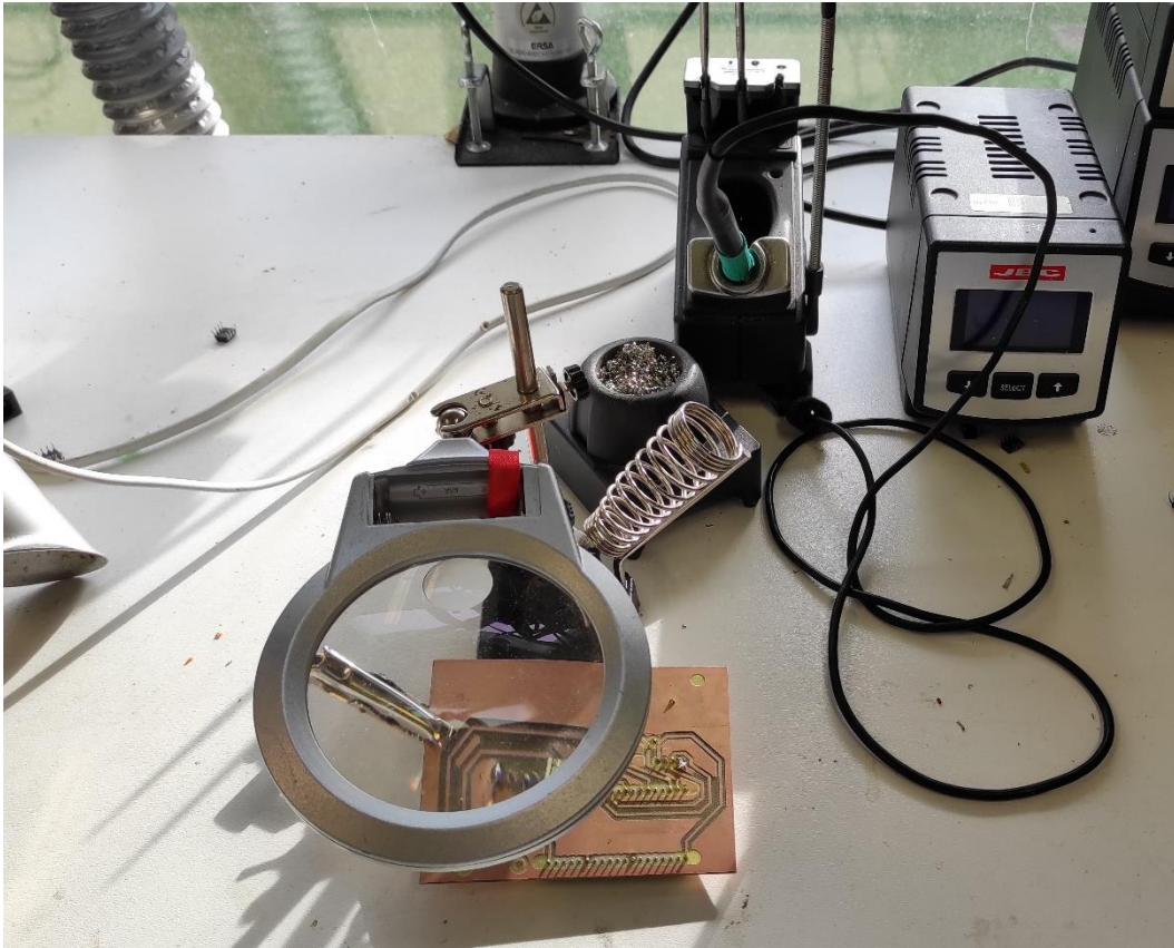
Figura 28. Puesto de soldadura con la PCB lista para trabajar en ella
