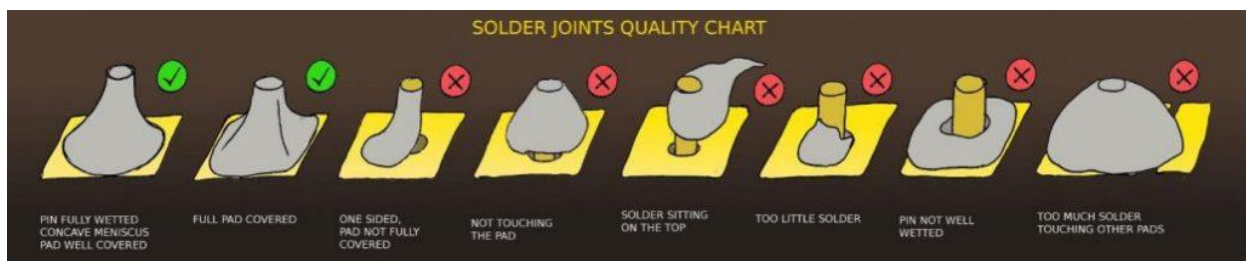
Figura 27. Comparación de calidad de soldaduras
