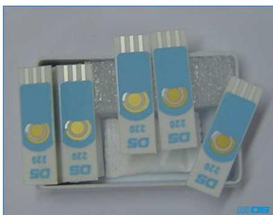
**Figura 3.7.** *Electrodos serigrafiados de oro.*
