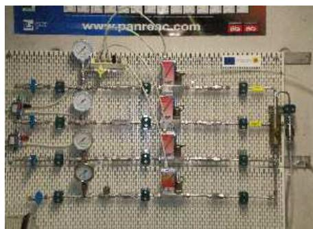
**Figura 3.15.** Conductos y válvula de mezcla por donde circulan los gases.
