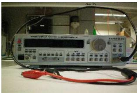
**Figura 3.18.** Imagen del conjunto del generador de funciones con los cables de cocodrilo.
