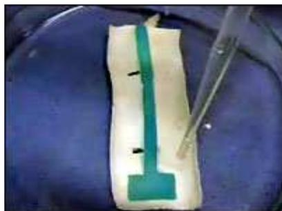
**Figura 2.1.** “Biotex”: Imagen de la fibra textil junto a los sensores ópticos y electroquímicos.
