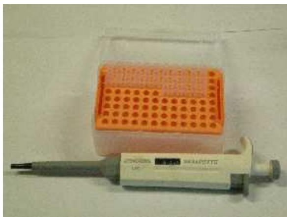
**Figura 3.20.** *Imagen de una pipeta de 50µl acompañada de recambios.*
