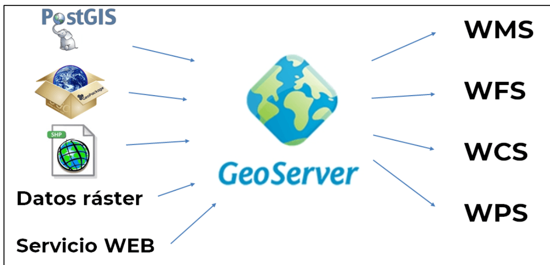
Ilustración 56. Diseño de interoperabilidad facilitado por GeoServer. Fuente: MappinGIS.
