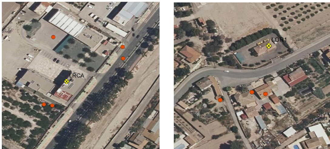
Figura 34. Posición de los puntos empleados para realizar la corrección y estaciones GNSS
