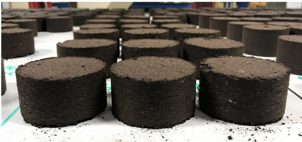
Figura 22. Briquetas de marro de café fabricadas durante la investigación.
