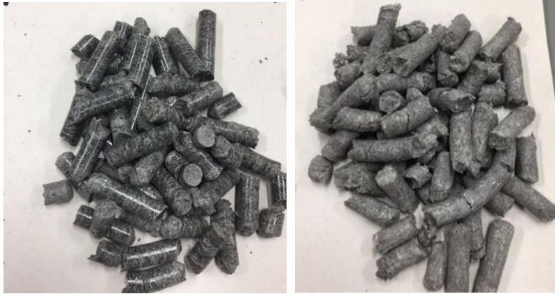
Figura 37. Pellets de CFP fabricados con un 10% de humedad (izq.) y un 40% de humedad (dcha.).
