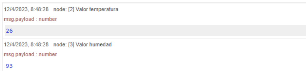
Figura 8.5 Valores de temperatura y humedad extraídos del mensaje JSON y mostrados en el debug.
