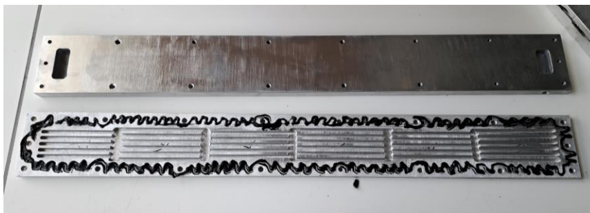
Figura 52. Colocación de la silicona sellante para evitar fugas de agua en el hotplate
