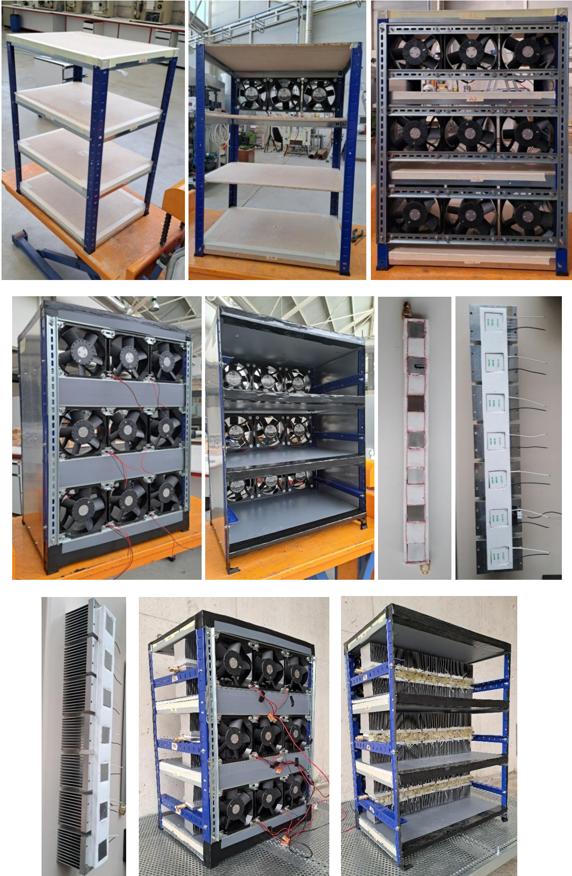
Figura 63. Proceso de fabricación de la bomba de calor aire – agua.
