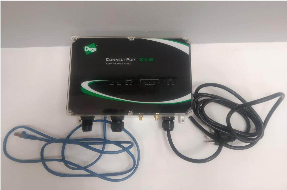
**Figura 50. Equipo Digi ConnectPort X4H con cables ethernet (azul) y alimentación (negro).**
