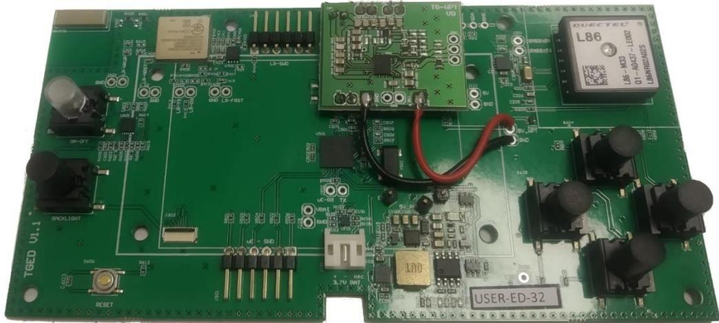
Figura 25. Imagen superior de placa TGED y placa auxiliar WPT sobre ella.
