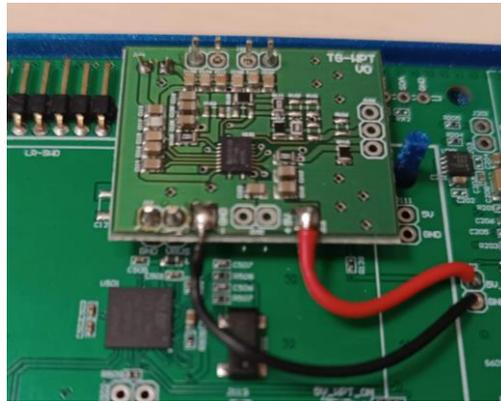
Figura 24. Montaje de placa auxiliar WPT sobre tarjeta PCB User-ED.
