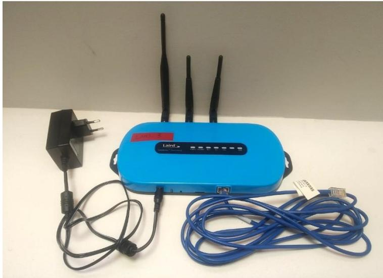
Figura 53. Foto del gateway RG186 de Laird utilizado en las pruebas.
