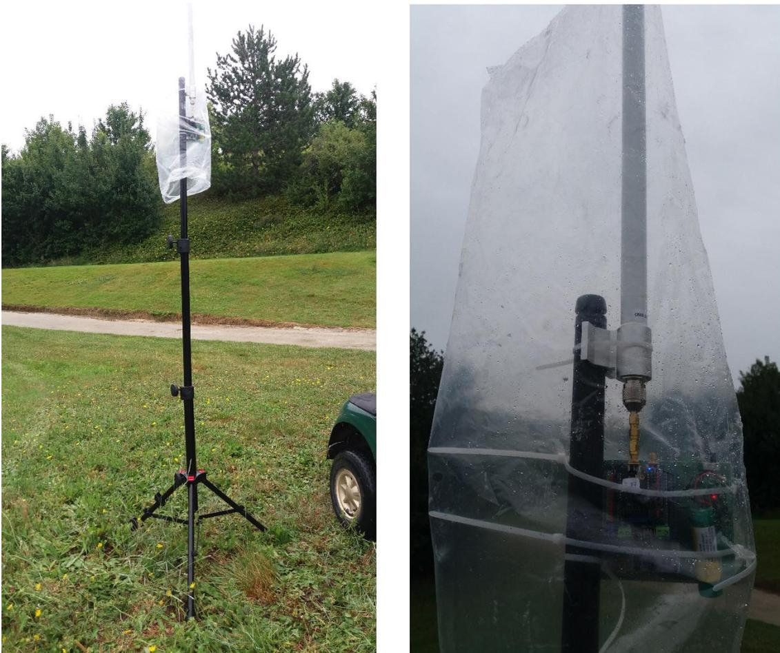
**Figura 49. Fotos del montaje de un enrutador Zigbee, protegido por plástico para la lluvia, dado que el dispositivo no tiene ninguna protección.**
