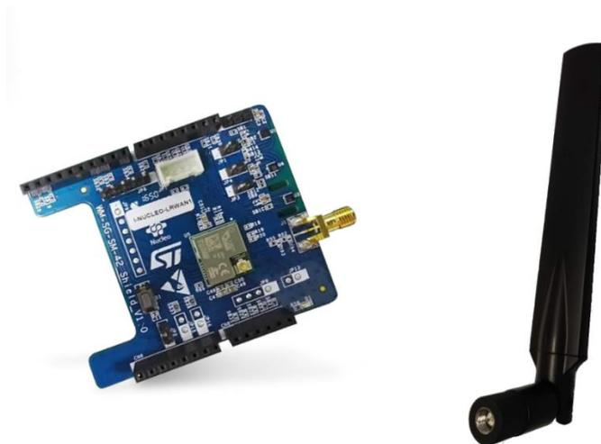
Figura 16. Placa I-NUCLEO-LRWAN1 y antena 868 MHz.
