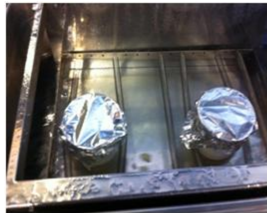
Figura 10: Baño termostático empleado para la desnaturalización de la proteína WPI.
