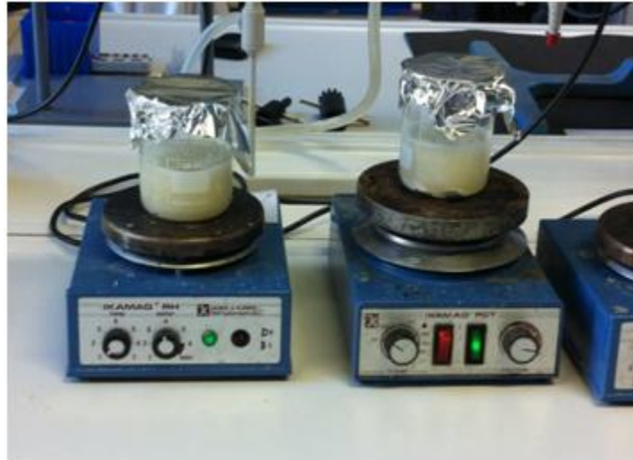
Figura 9: Soluciones formadoras de película en agitación en los agitadores magnéticos
