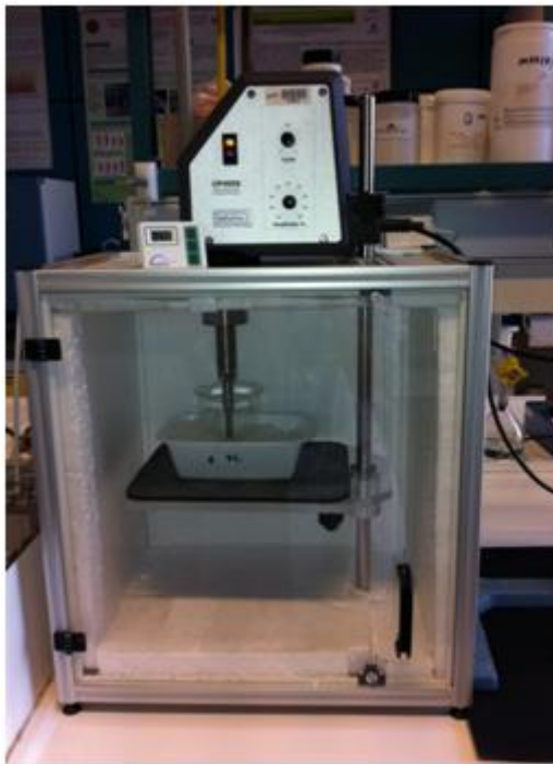
Figura 11: Homogeneización de la solución por ultrasonidos
