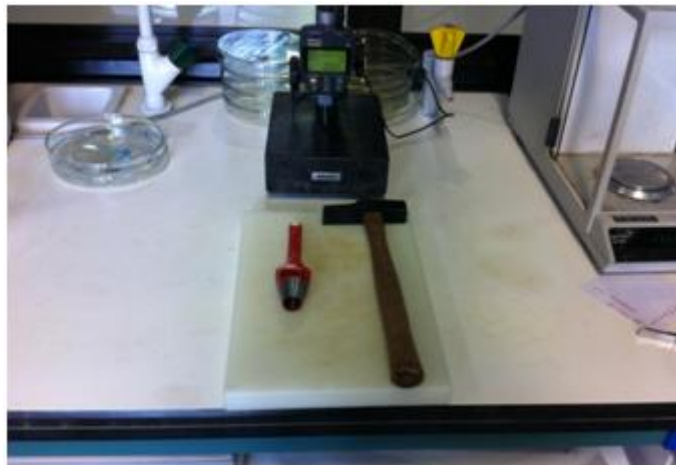
Figura 16: Herramientas para realizar discos de 17mm
