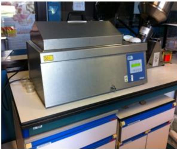
Figura 10: Baño termostático empleado para la desnaturalización de la proteína WPI.
