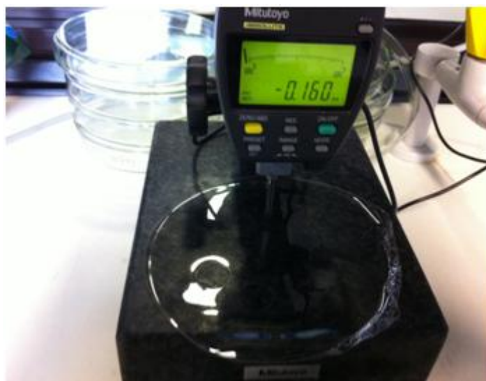
Figura 14: Micrómetro digital empleado para la medida del grosor .
