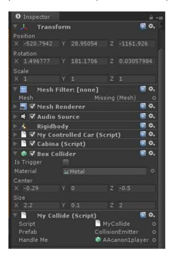
Como vemos el tanque esta formado por un rigidbody y un collider y tiene asociados 3 scripts. Estos son los componentes del tanque, jeepbody es el model del tanque en 3d, cameras contiene todas las cámaras y todo esta dentro de aacanon1player que es el tanque en global.
