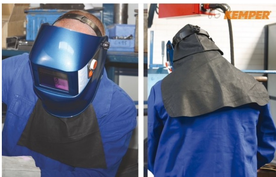
Ilustración 39 Careta de soldador y protección de cabeza y cuello.
