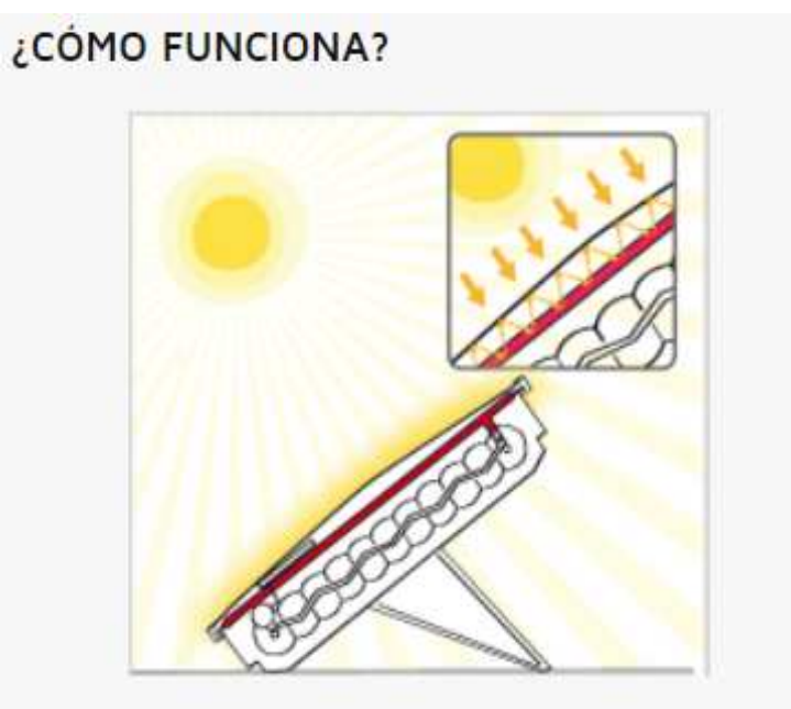
Imagen 24. Funcionamiento del colector solar TODO EN UNO SOT-150
