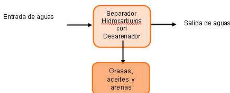
Imagen 5. Elementos obligatorios en el tratamiento de aguas
