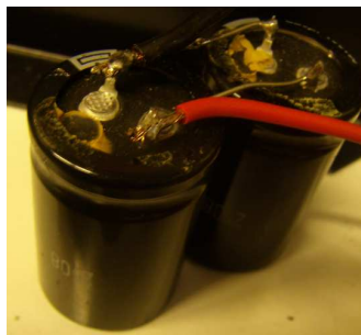
figura 2.9.- Condensadores de entrada
