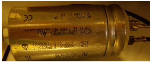
figura 2.12.- Condensador del filtro de salida
