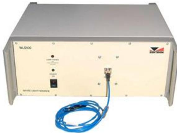
Ilustración 1: Fuente de luz blanca halógena de 100W de la casa bentham (1)
