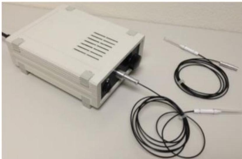
Ilustración 2: Fuente de luz láser blanca mediante fibra dopada con fosforo. Laser dopado (2).
