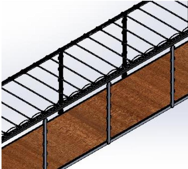
*Ilustración 12. Montaje de los Arquillos para plegador del techo*
