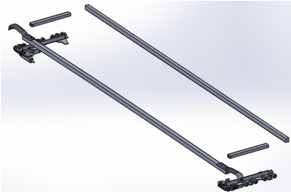
*Ilustración 29. Vista explosionada del carro final-terminación con amortiguadores*
