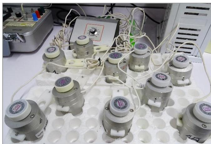
Figura 10: Microvoltímetro con 10 cámaras utilizado para determinar el potencial hídrico nodular.
