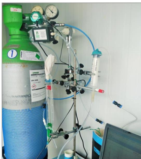
Figura 14: Detector amperométrico utilizado en la determinación de la actividad aparente nitrogenasa (ANA).
