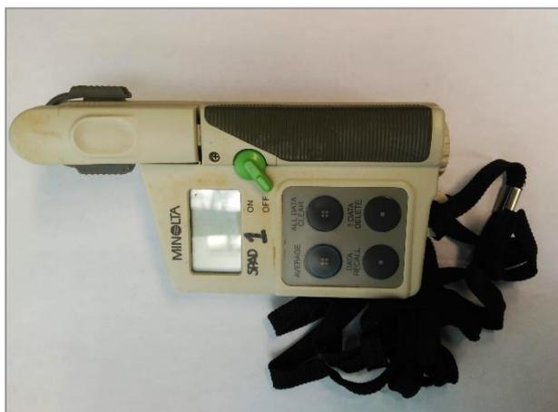
Figura 11: Clorofilómetro portátil (Minolta Chlorophyll Meter, SPAD-502) utilizado para determinar el índice SPAD.
