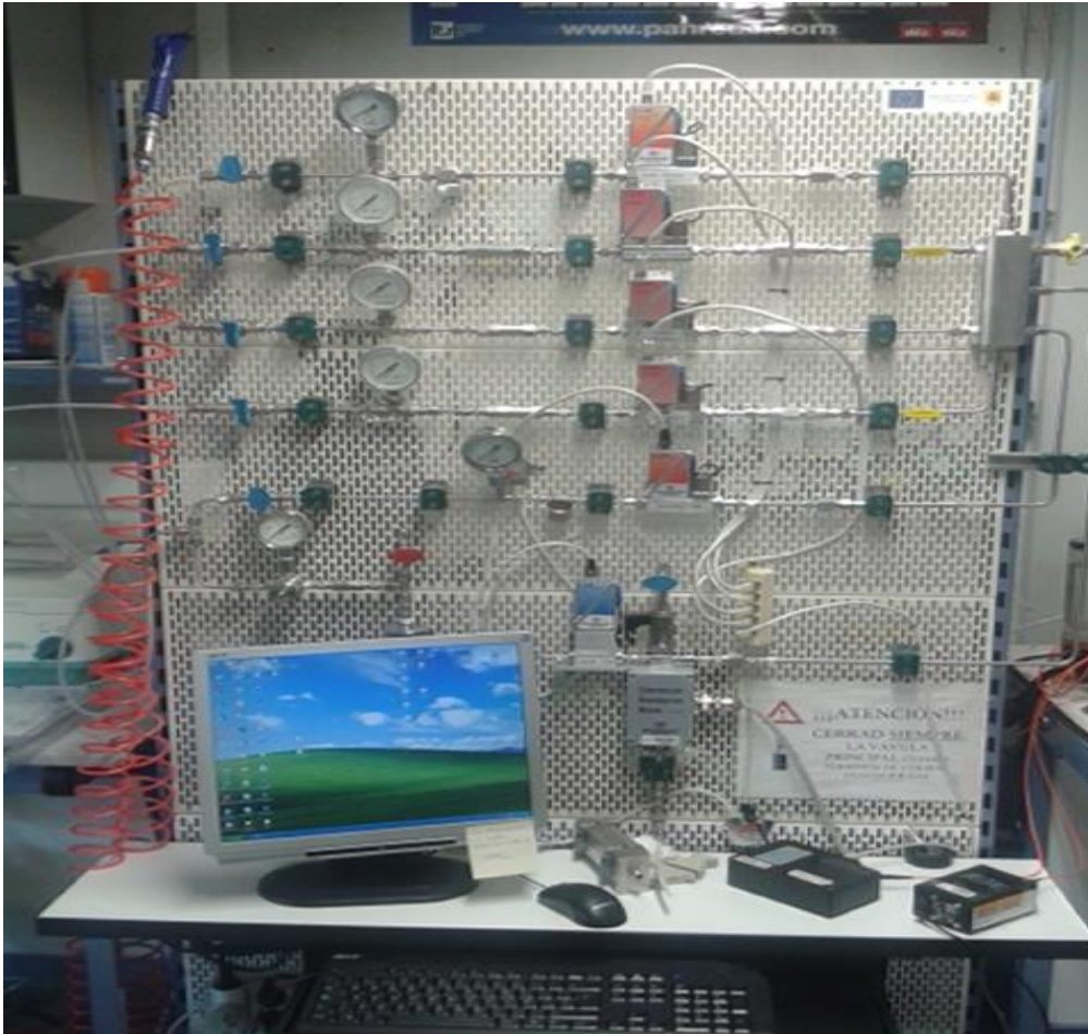
Figura 10. Panel de control de gases.
