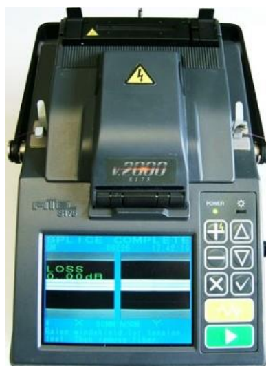
Figura 17. Fusionadora Fitel S175 con fibras SMF posicionadas para fusionado.
