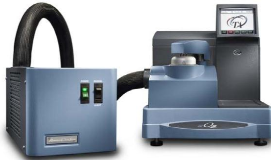
Figura II.VII: Dispositivo DSC TAQ100 utilizado en la caracterización de la aleación.
