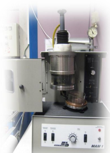
Figura II.1: Horno de Arco del Laboratorio.
