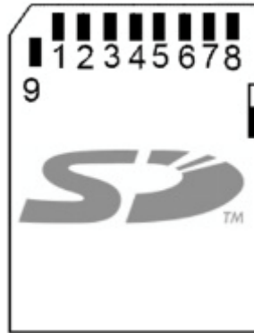
Figura 24. Configuración de pines de la tarjeta SD.
