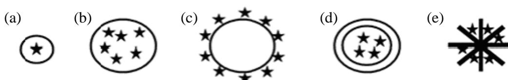
**Figura 2.** Mecanismos de liberación: (a) enlace químico, disolución; (b) degradación, disolución, dispersión, adsorción; (c) adsorción físico/química, enlaces químicos, deposición capa a capa; (d) coacervación, encapsulación; (e) atrapamiento.
