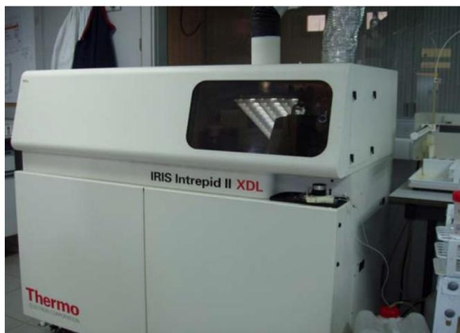
**Figura 9.** Equipo ICP-OES IRIS INTREPID II XDL THERMO del CSIC.
