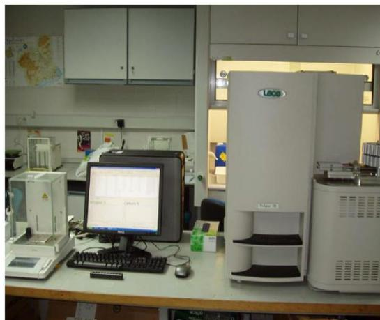
**Figura 8.** Analizador LECO TRUSPEC CN utilizado por el CSIC.
