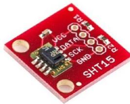
Figura 2.6. SHT15 montado en una placa comercial incluyendo el condensador de desacoplo y las resistencias de pull-up y pull-down. [16]
