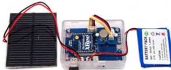
Figura 2.1. Partes diferenciadas de un sensor inalámbrico con un panel solar. [I2]
