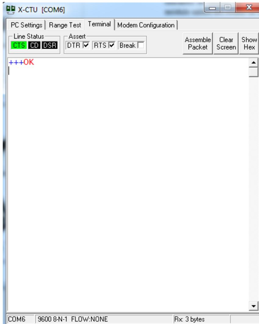
Figura 2.22. Entrada en el modo de comandos mediante el software X-CTU.
