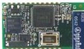
Figura 2.18. Módulo ZB-21 ZigBee OEM. [I17]
