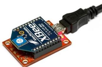
Figura 2.26. Conexión del módulo Xbee al Explorer USB. [I19]
