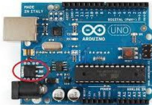
Figura 2.30. Localización del regulador en la placa Arduino Uno. [19]
