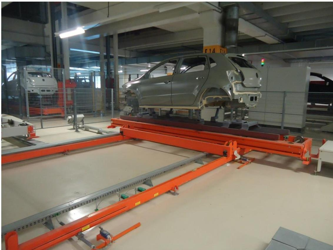
**Ilustración 52 - Fotografía carro transportador**
