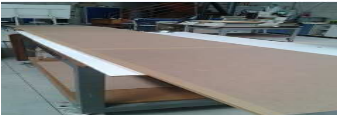
IMAGEN 80, 81 Y 82: PROTECCIÓN DE LOS CANTOS
