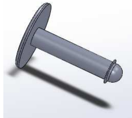
IMAGEN 71 Y 72: CLIPS MACHO-HEMBRA PARA SUJECIÓN DE ESTRUCTURA
