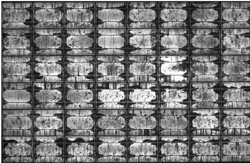
Fig 5: Imagen EL de un panel solar tras el DHT.
