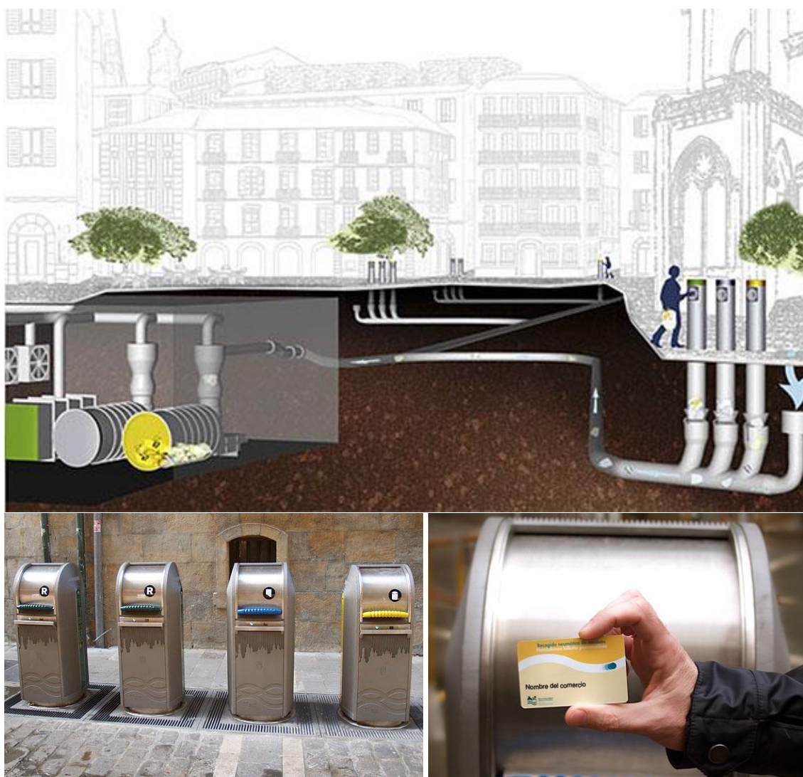
Figura 92: Recogida Neumática de residuos del Casco antiguo de Pamplona Fuente: Mancomunidad de la Comarca de Pamplona
