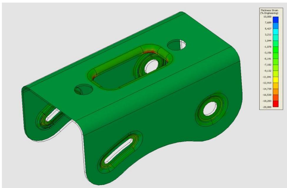
**Fig. 7: Análisis de espesores.**
