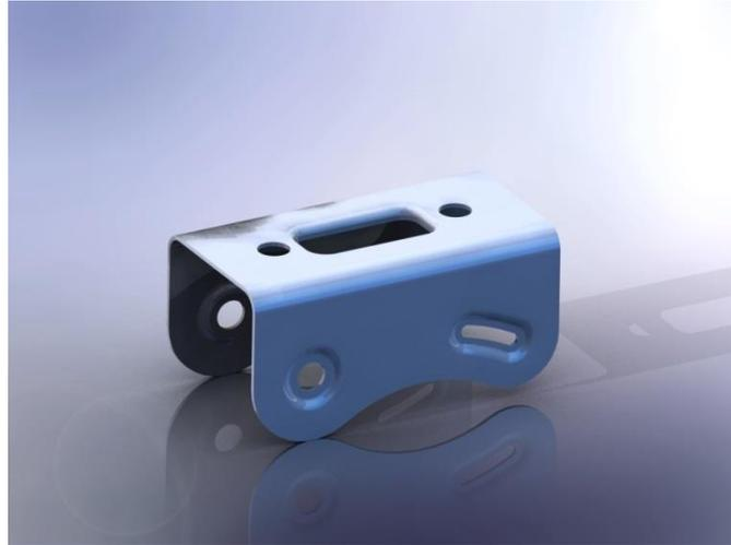
**Fig. 1: Modelo de la pieza estampada que debemos construir.**
