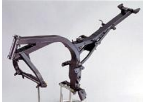
Figura 4.14-Chasis de espina central
