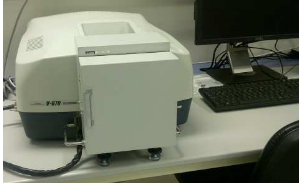
Figura 25. Espectrofotómetro con esfera integradora acopalda
