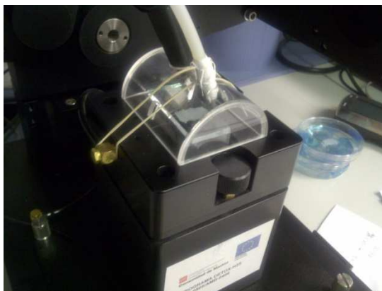
Figura 31. Cámara de control de humedad relativa acoplada al portamuestras del elipsómetro
