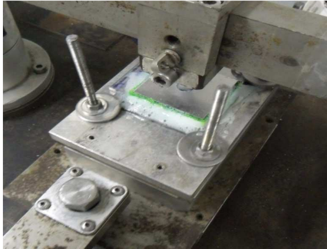
Figura 37. Fotografía del montaje del ensayo de abrasión
