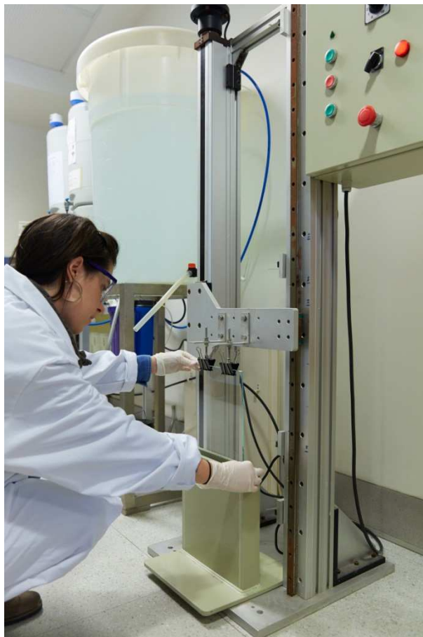
Figura 85. Equipo de inmersión-extracción para escalado, y cuba de polipropileno construida a medida
