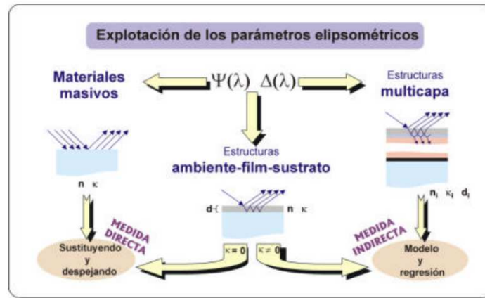
Figura 30. Esquema de la explotación de los parámetros elipsométricos [70]
