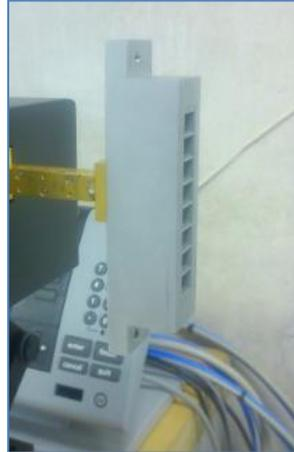
*Figura 5.17: Array de 8 antenas*
