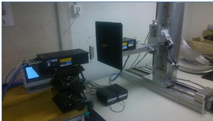
*Figura 5.18: Sistema de medida Array de 8 antenas en banda WR 2.2*
