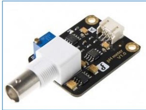
Ilustración 6. pH meter V1.0 (<http://tienda.bricogeek.com/otros/581-sensor-analogico-de-ph.html>)
