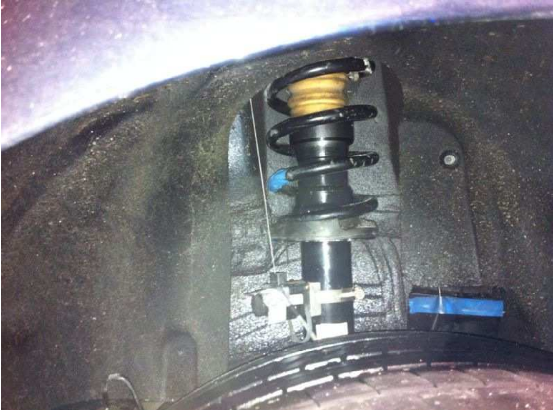
Figura 113. Sensor de hilo instalado
