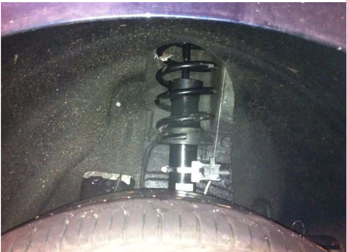
Figura 114. Sensor de hilo instalado
