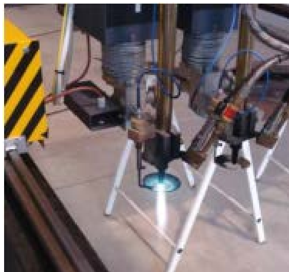
Ilustración 104: Llama de precalentamiento
