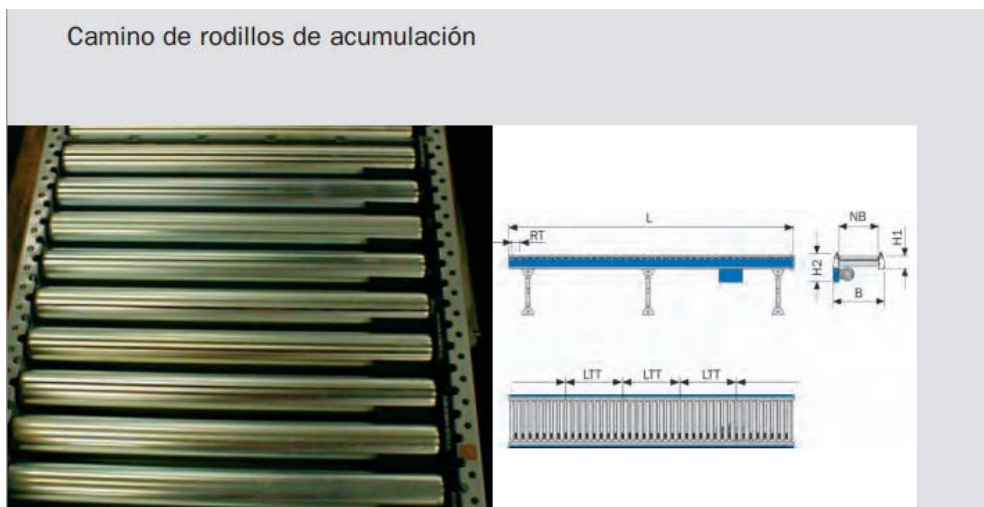
Ilustración 71: Sistema de rodillos de acumulación
