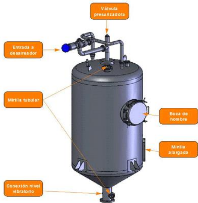
Componentes del depósito desaireador
